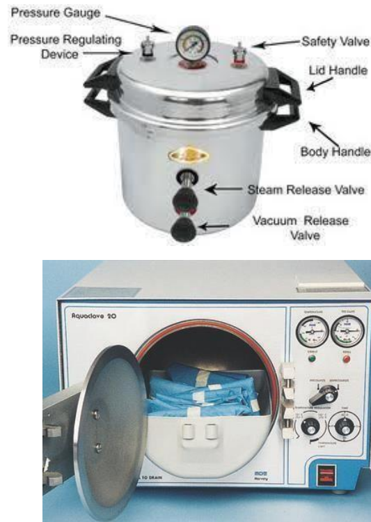
Gambar 4.1. Manual Autoclave (Aquaclave) (Khadka S, et al , 2008)
